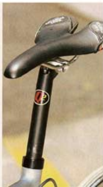
Além do quadro, os detalhes ficam por conta do garfo, que é todo em fibra de carbono, o conjunto canote Q2 e selim San Marco Aspide. Acima, guidão e mesa FSA, e abaixo, o conjunto Shimano Dura-Ace
